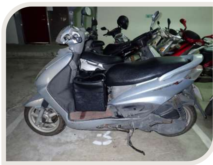
★ 機車腳踏板空間擺放加熱示意圖 保溫袋外觀尺寸：310×280×310mm
